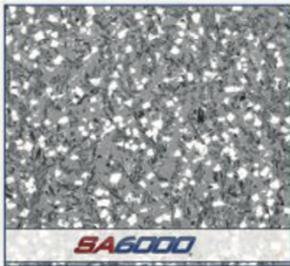
La microestructura patentada de SA6000 es altamente refinada con carburos complejos compactos. Esta microestructura de grano fino reduce la propagación de grietas, lo que otorga una resistencia superior al impacto.
