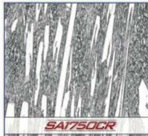
A modo de comparación, lo mostrado arriba es la microestructura de la placa de revestimiento de carburo de cromo SA1750CR. Pueden ver los carburos mucho más grandes dentro de la microestructura. Estos carburos grandes reducen la resistencia al impacto del material.
