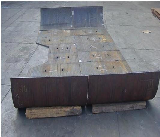
Se utiliza el recubrimiento en componentes de equipos de movimiento de tierra, chutes de descarga o sectores donde se tenga un impacto mediano indirecto y alta abrasión
